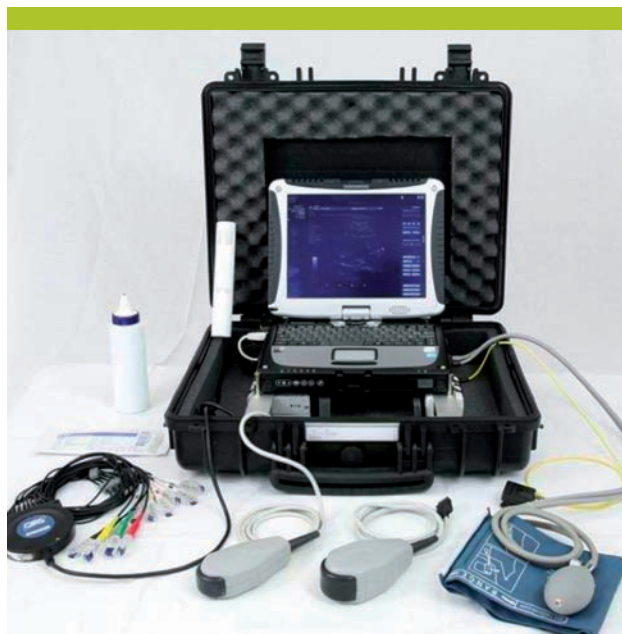
Figure 1. Valise de télémédecine issue des programmes européens Resamu, Medmont et Resamont, comprenant électrocardiogramme, tension artérielle, saturation artérielle en O 2 , spirométrie et échographie
