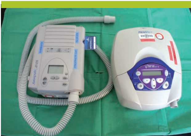
Figure 1. Appareils de ventilation barométrique à deux niveaux de pression
